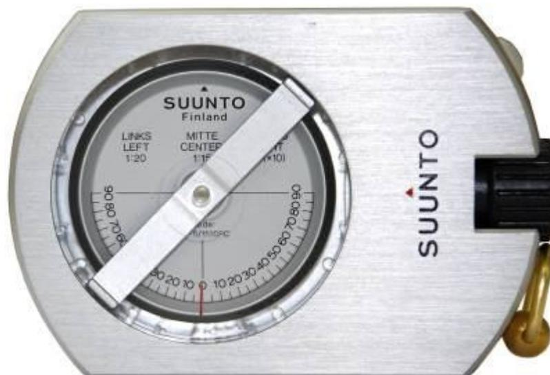
С помощью высотомера Suunto PM-5/1250 можно точно и быстро измерять высоту деревьев. Разрешающая способность  $\pm 1-2\%$ . Наводка и взятие отсчета по шкале происходят одновременно. Регулирование или блокировка шкалы не требуются. На высотомере имеются шкалы для измерения, высоты с расстояния 15 и 20 м.
